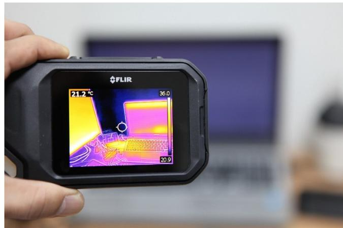
Die Kamera erstellt anhand der gemessenen Infrarotstrahlung elektronisch ein Bild, das die Verteilung der Oberflächentemperatur des zu messenden Gegenstands darstellt.
